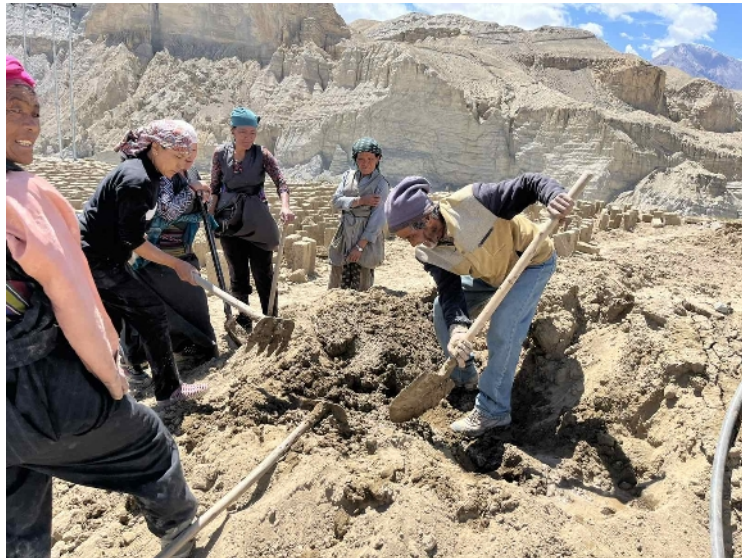
Préparation de l'argile pour mouler des briques.
